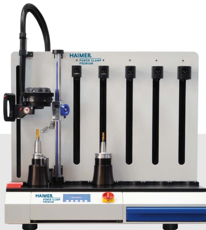
Abbildung zeigt 80.170.00NG mit optionaler Längenvoreinstellung Picture shows 80.170.00NG with optional length presetting
